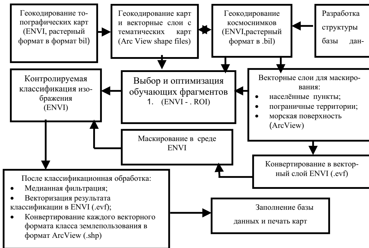
Рис. 2. Схема информационных потоков при картографировании классов землепользования (.ROI –формат ENVI, .evf, .shp –векторные форматы, .bil -растровый).
