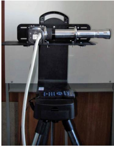
Рис. 7. Поворотная платформа, на которой установлен гиперспектрометр
