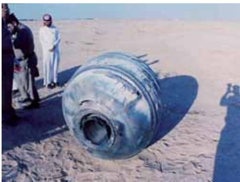
**Рис. 3.4.** Главный титановый кожух твердотопливного двигателя верхней ступени РН «Дельта» (240 км от Эль-Рияда, 70 кг) [PAM-D Debris..., 2001]
