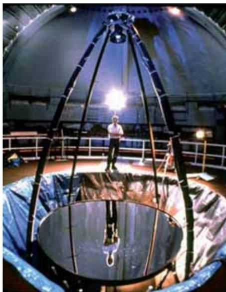
**Рис. 1.25.** Трехметровый телескоп НАСА с жидким зеркалом
