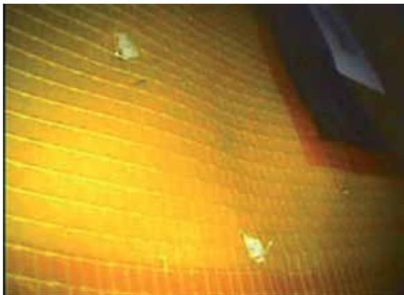
**Рис. 3.27.** Повреждения термозащитного одеяла под панелью радиатора
