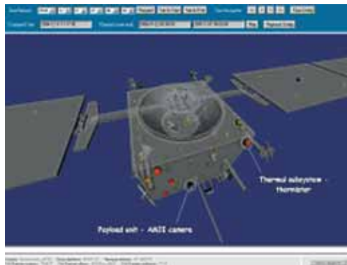
Рис. 2.8. 3D-модель Smart-1 с окрашенными термодатчиками. Цвета отражают фактическую температуру, получаемую из ТМИ ( http://www.esa.int/Our_Activities/Operations/Virtual_Spacecraft_br_Enhanced_Monitoring_Diagnostics_through_Virtual_Reality )
