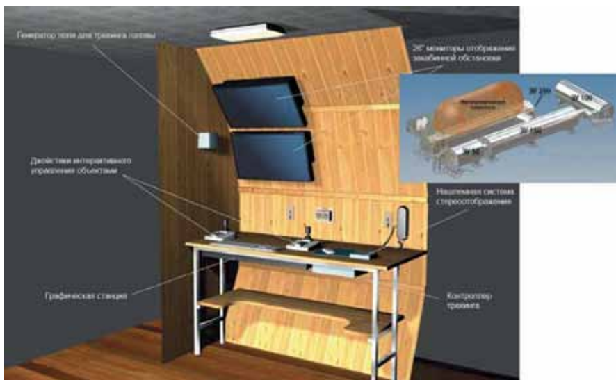
Рис. 3.2. Аппаратный комплекс для моделирования деятельности космонавтов на поверхности Марса (проект МАРС-500) [Группа Джей Си, 2010]
