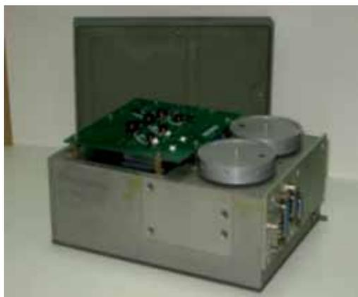
Рис. 3. Внешний вид блока управления системой ориентации
