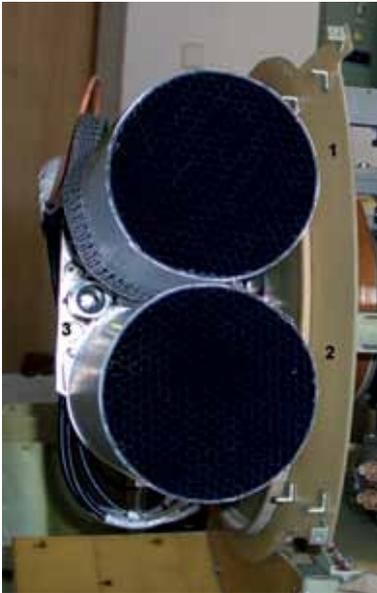
**Рис. 1.** Объективы пеленгатора и информационного приёмника с сотовыми блендами
