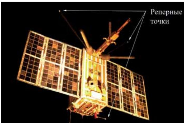
Рис. 4. Микроспутник «Чибис-М» и реперные точки
