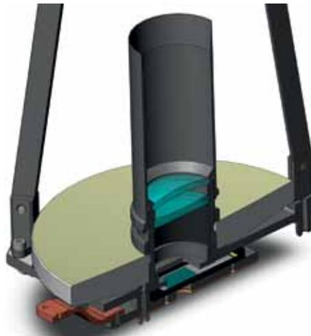
Рис. 2. Сборка основания главного зеркала (разрез)
