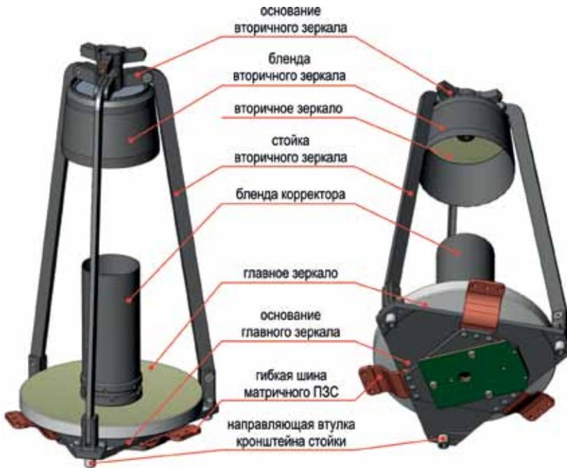
Рис. 1. Оптический блок звёздного датчика
