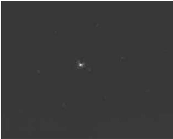
**Рис. 8.** Дифракция на сотовой бленде (яркость искусственно завышена, чтобы дифракционные максимумы были видны на рисунке)
