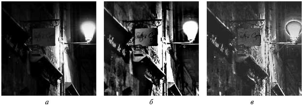
Рис. 3. Улучшение изображения: а — исходное изображение; б — Гаусс; в — алгоритм KNV
