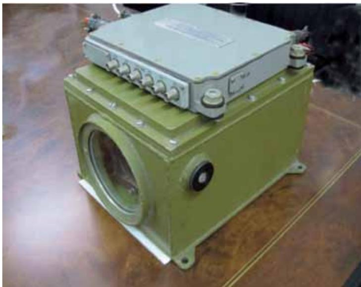
Рис. 1. Видеокамера и мультиплексор в защищенных корпусах
