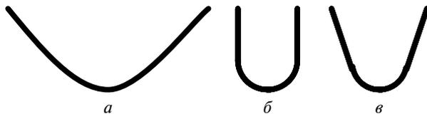
Рис. 2. Различные модели туннельных оболочек
