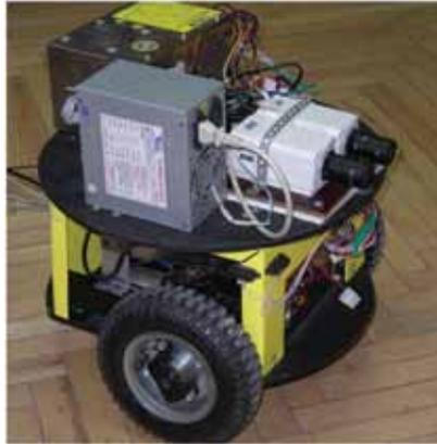
Рис. 3. Система визуальной одометрии на мобильном роботе
