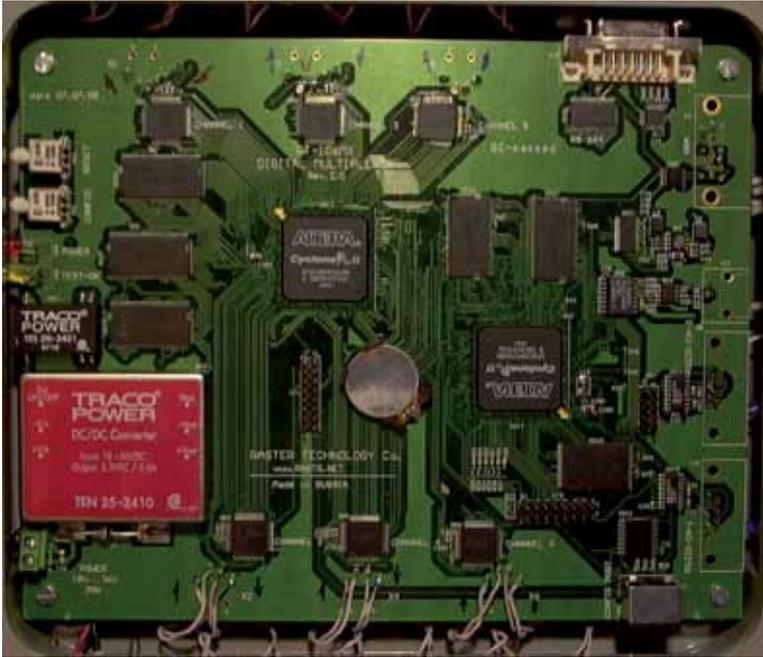
Рис. 3. Печатная плата мультиплексора RT-106MX
