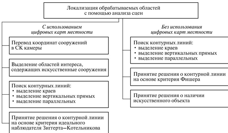
Рис. 2. Схема алгоритма локализации обрабатываемых областей
