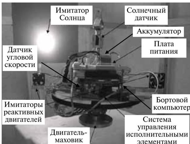
Рис. 5. Макет с гироскопическими элементами
