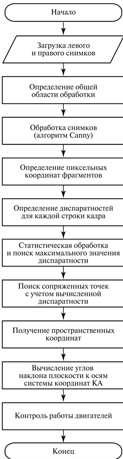
Рис. 4. Алгоритм обработки изображений и управления манипуляторами
