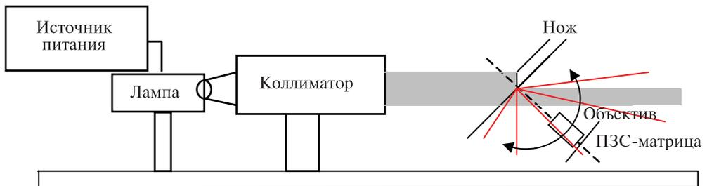
**Рис. 14.** Схема эксперимента для измерения рассеяния на кромке диафрагмы
