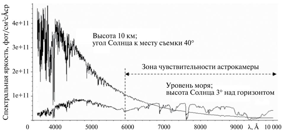
Рис. 17. Спектральная яркость атмосферы при съемке с Земли и с высоты 10 км
