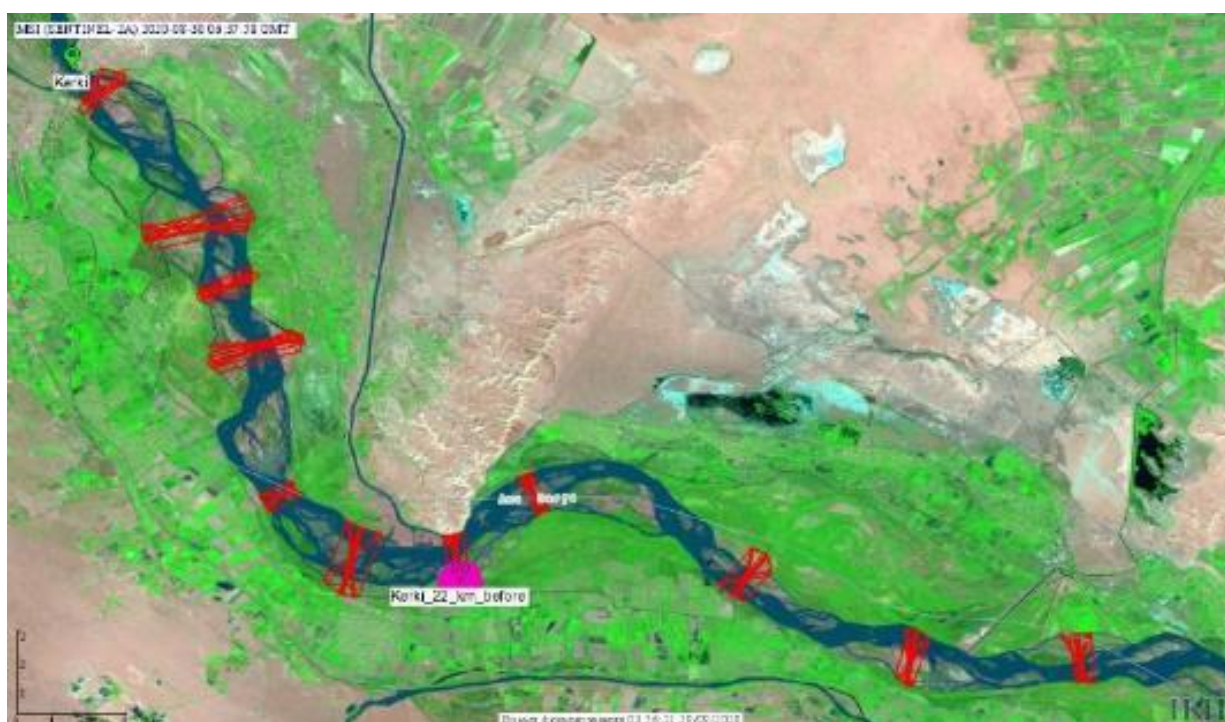
Рисунок 1.2.3.2 — Группы космических гидропостов, заведённые на определённом расстоянии от станции Керки в системе EcoSatMS
