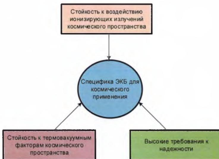
Рисунок 4.1 Специфика электронной компонентной базы (ЭКБ) для космического применения
