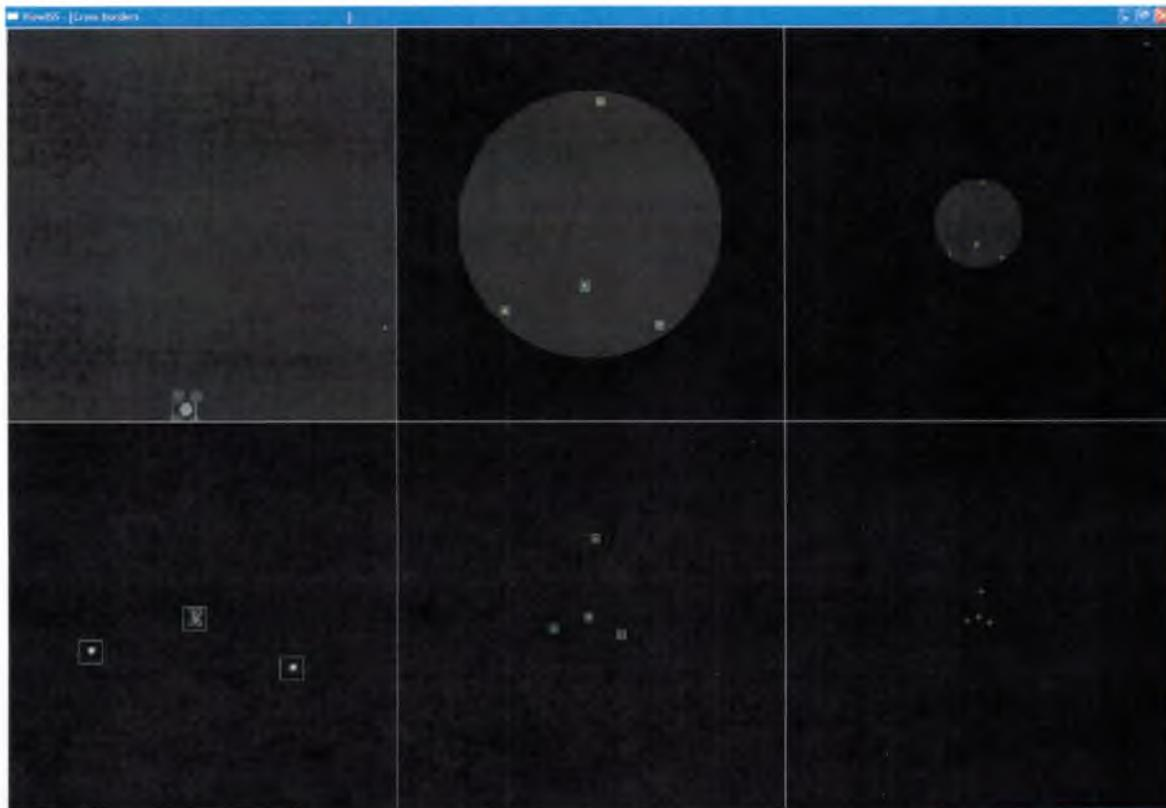
Рисунок 1.1.3.1. Изображения мишеней КА, с которыми производится стыковка. Первая камера (верхний ряд по горизонтали) и вторая камера (нижний ряд по горизонтали) различаются фокусным расстоянием и устройствами подсвета. Изображения различаются масштабом (левая колонка – масштаб 1:1, средняя колонка – 1:3, правая – 1:9).
