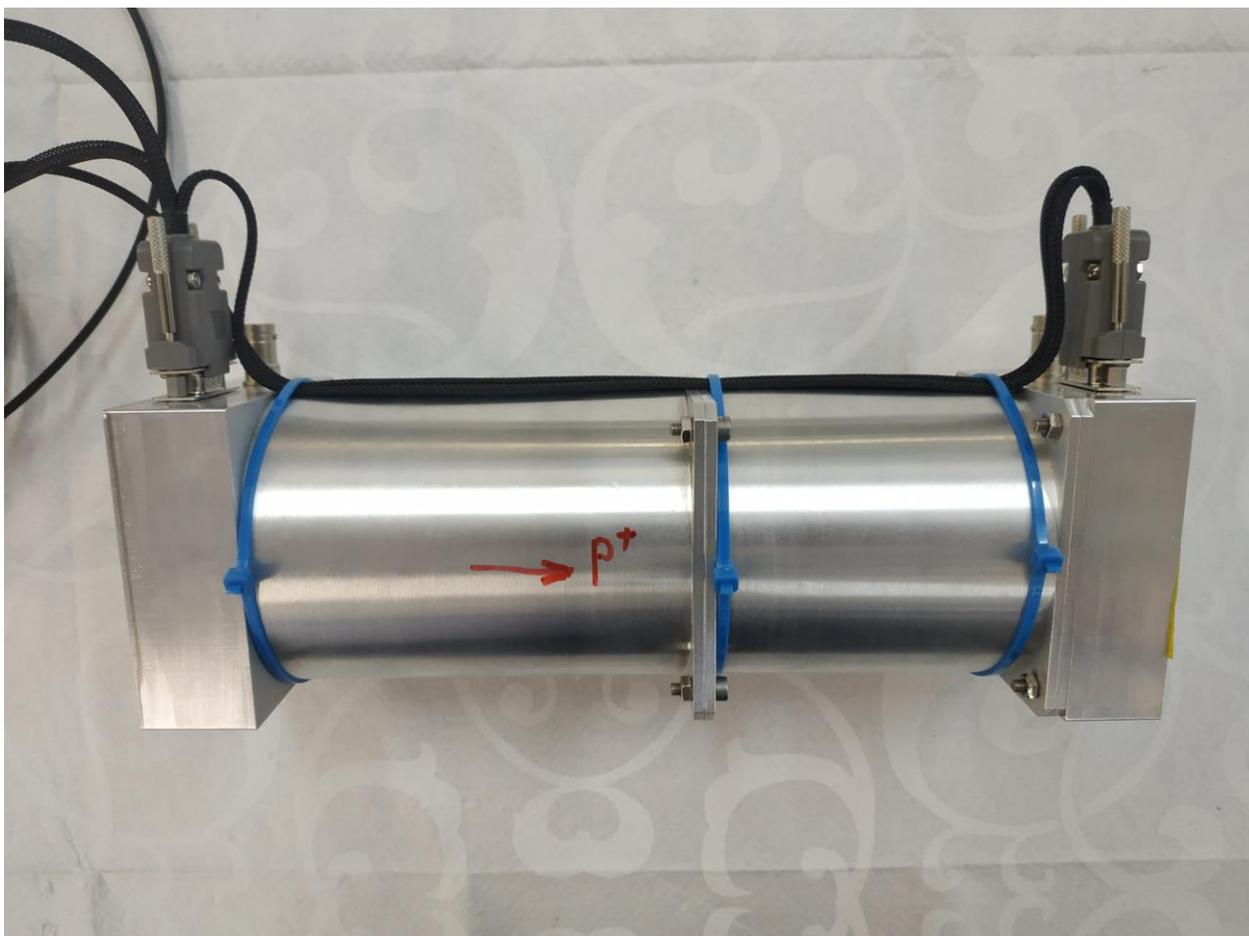
**Рис. 5-9.** Прототип нейтронного детектора с антисовпадательной защитой
