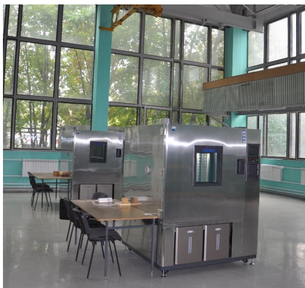
Рис. 6.5 Внешний вид климатических камер Terchy в помещении КИС Института
